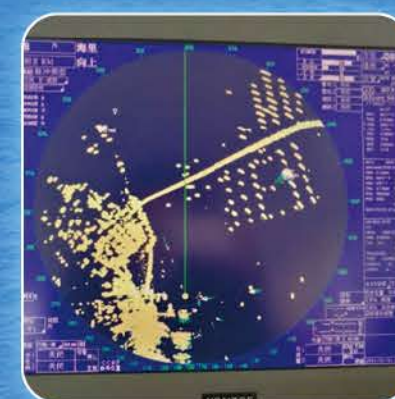
海浪抑制效果良好，小目标探测能力强， 3NM和6NM偏心显示，带对地真尾迹。
